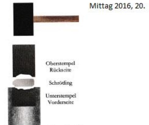
Abb. 1: schematische Darstellung des Prägevorgangs
